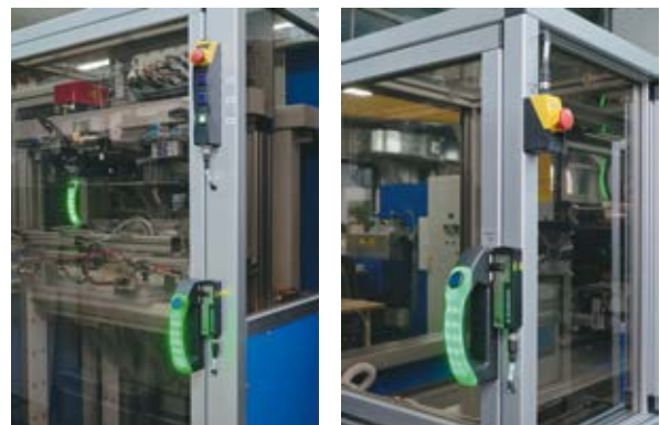
Bild 4 links: Für zusätzliche Bedienfunktionen wird ein separates Bedienfeld aus der BDF 100-Serie von Schmersal genutzt (oben im Bild).
