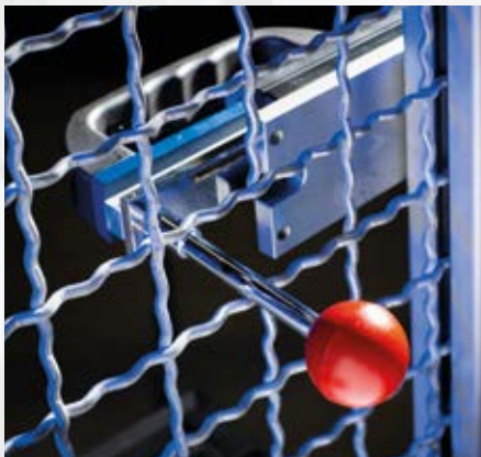
Asa esférica roja para abrir una puerta protectora desde la zona de peligro
