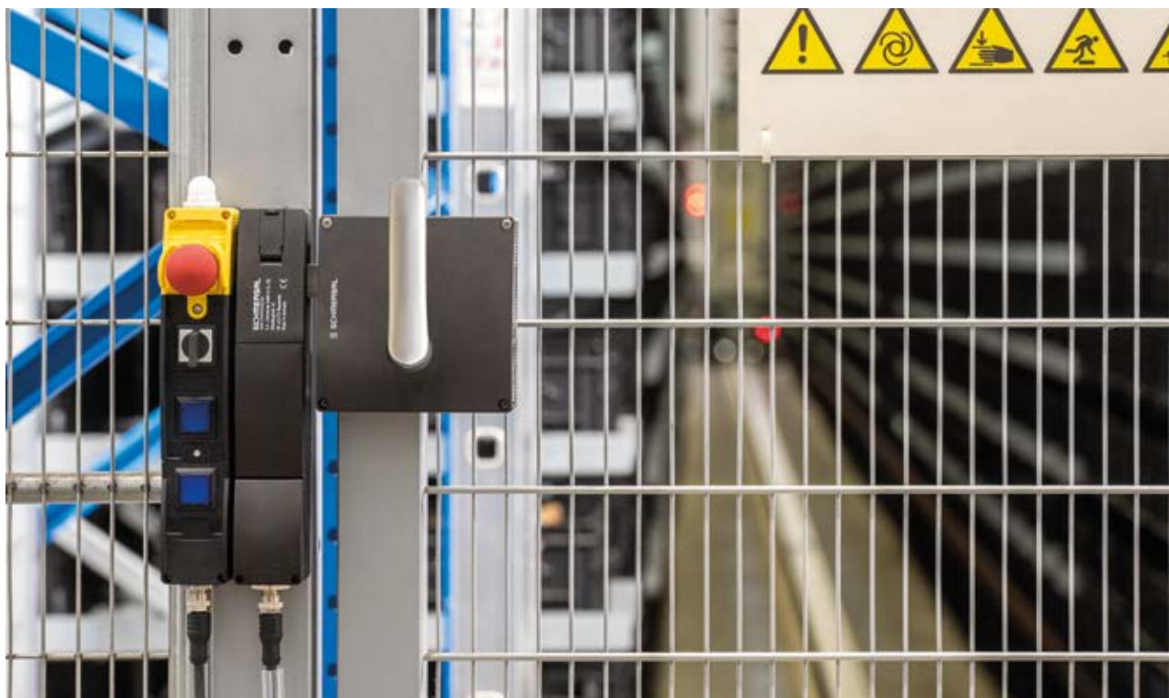
Sicherheitszuhaltungen wie die AZM201 von Schmersal dienen der Stellungenüberwachung von Schutztüren, z. B. an Roboterarbeitsplätzen.
